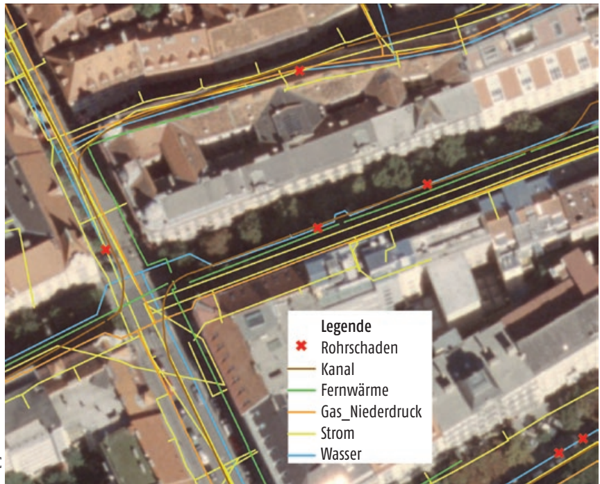
Abb. 2 – Verlegte unterirdische Infrastruktur im innerstädtischen Bereich der Stadt Graz
